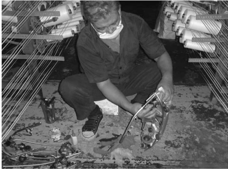
Gambar 5.2 Contoh *shuttle* saat diperbaiki
